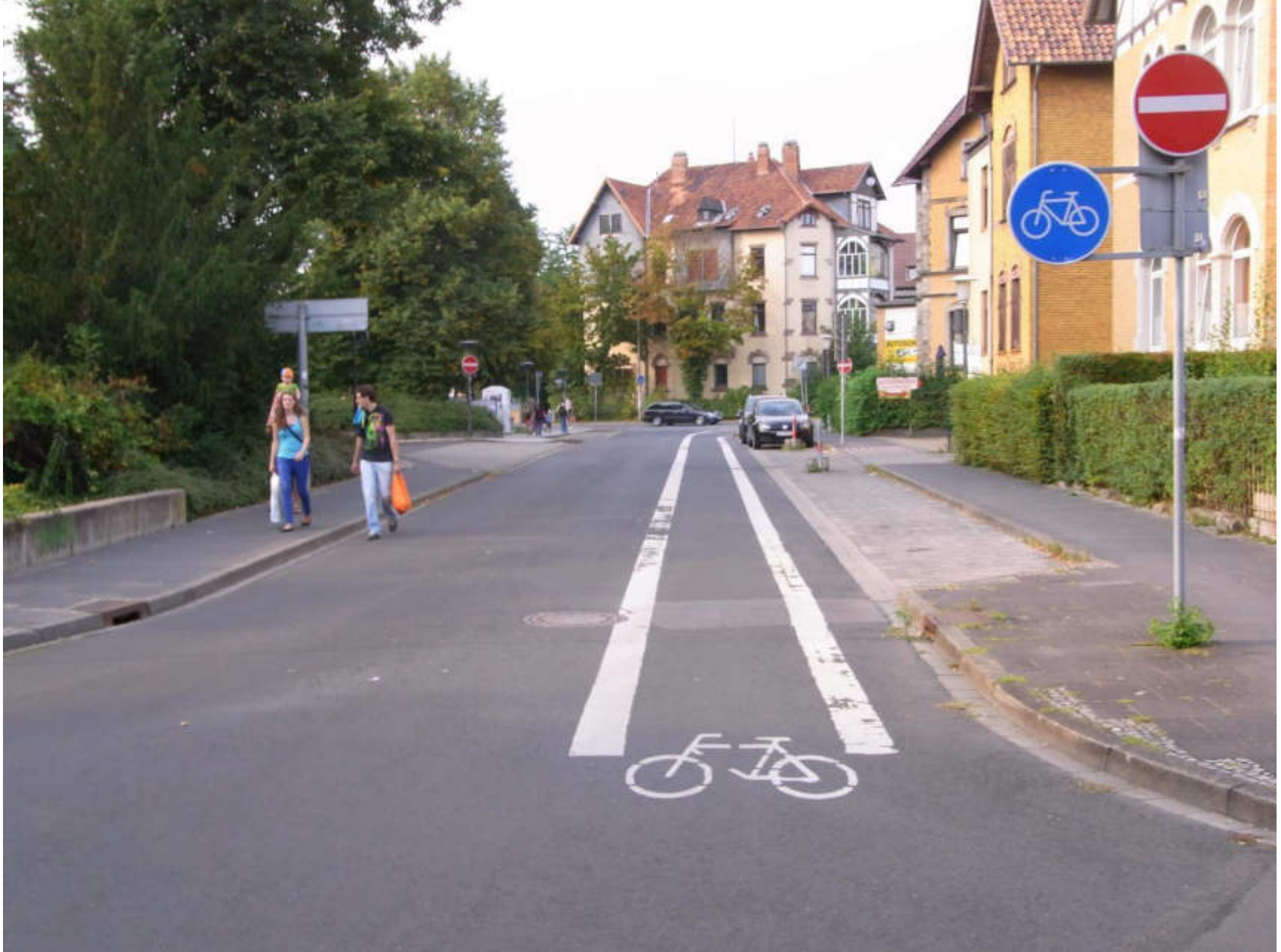
Lösung 3 von 7: Gegenläufiger Radfahrstreifen (durchgezogene Linie und Radwegeschild)
