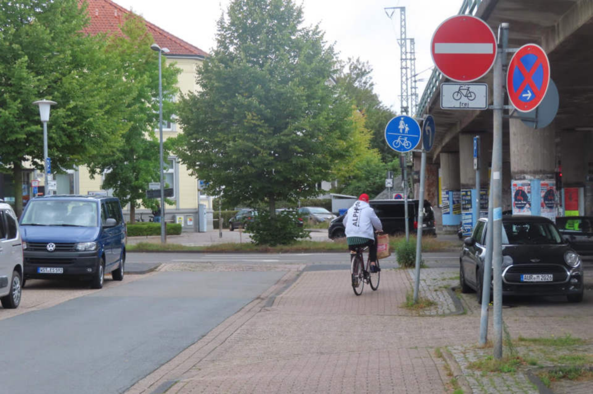
Lösung 5 von 7: Gegenläufiger Radfahrstreifen (gegenläufiger kombinierter Geh-/Radweg oder Gehweg mit Radverkehr frei)
