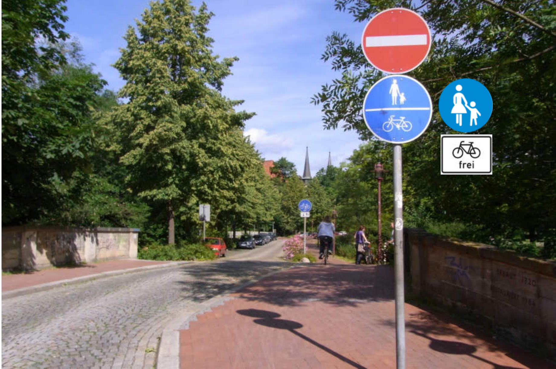
Lösung 5: Zulassung des Radgegenverkehrs auf dem Gehweg, hier durch StVO-Zeichen 240 (Kombinierter Geh-/Radweg, Alternative: Gehwegzeichen 239 + „Radverkehr frei“ StVO-Z. 1022-10)
